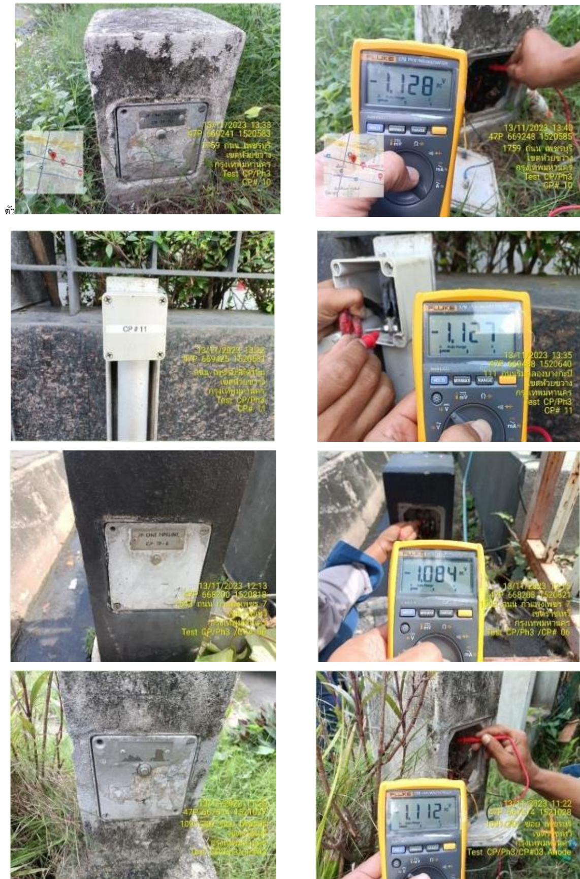
รูปที่ 2-10 ตัวอย่างการบำรุงรักษาแท่งแมกนีเซียม (Cathodic Protection) ตลอดแนวท่อ
